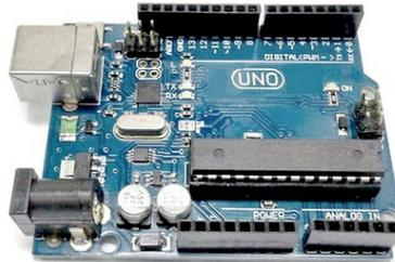
Рис. 2. Микроконтроллер Arduino Uno
