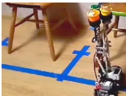
Рис. 2. Схема цветowych разметок на полу и мебели для считывания датчиками
