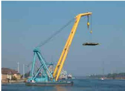
Рис. 1. Плавучий кран
