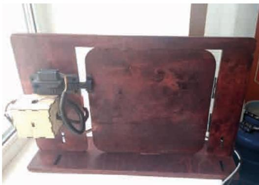
Рис. 3. Фото макета двери с замком
