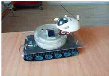
Рис.2. Гусеничный робот с ультразвуковым дальномером и передающей видеокамерой
