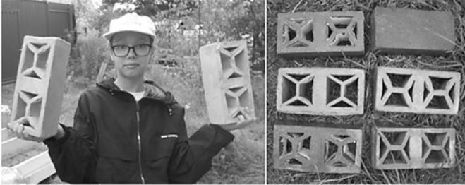
Рис. 1. Итог работы – новые опытные пустотелые кирпичи
